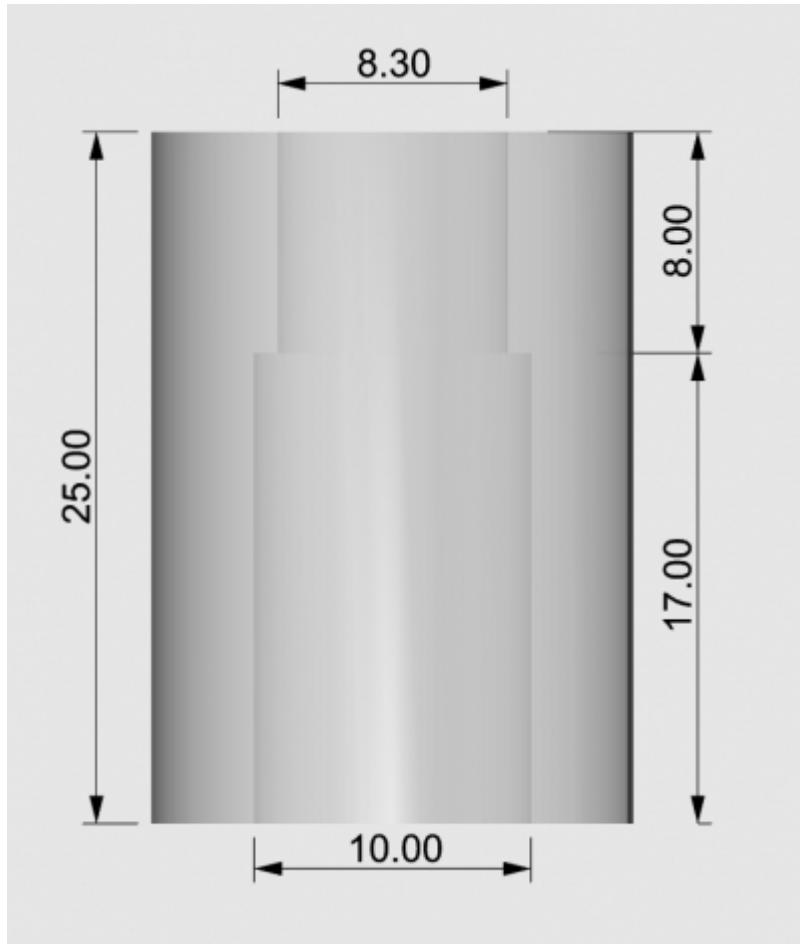
Im **Druckstück** ist eine Bohrung mit einem Gewinde M8 sehr hilfreich, um bei Nichtbenutzung den Werkzeugsatz zusammenschrauben zu können.
