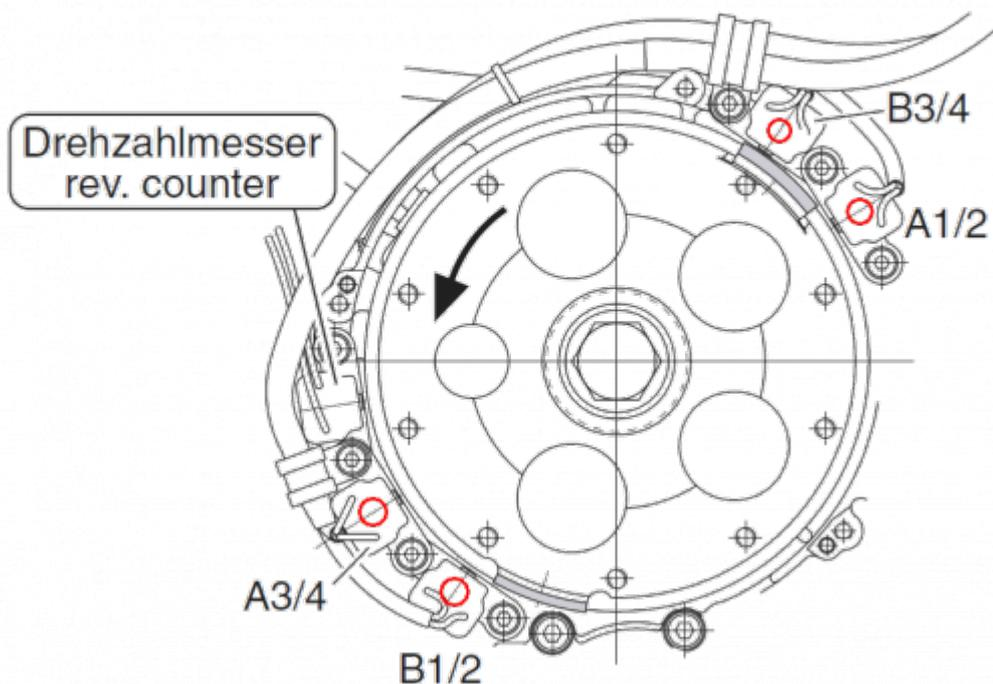
Nach Entfernen des schwarzen Zünderdeckels sieht man die einzelnen Zündgeber und den Geber für das Drehzahlsignal.
