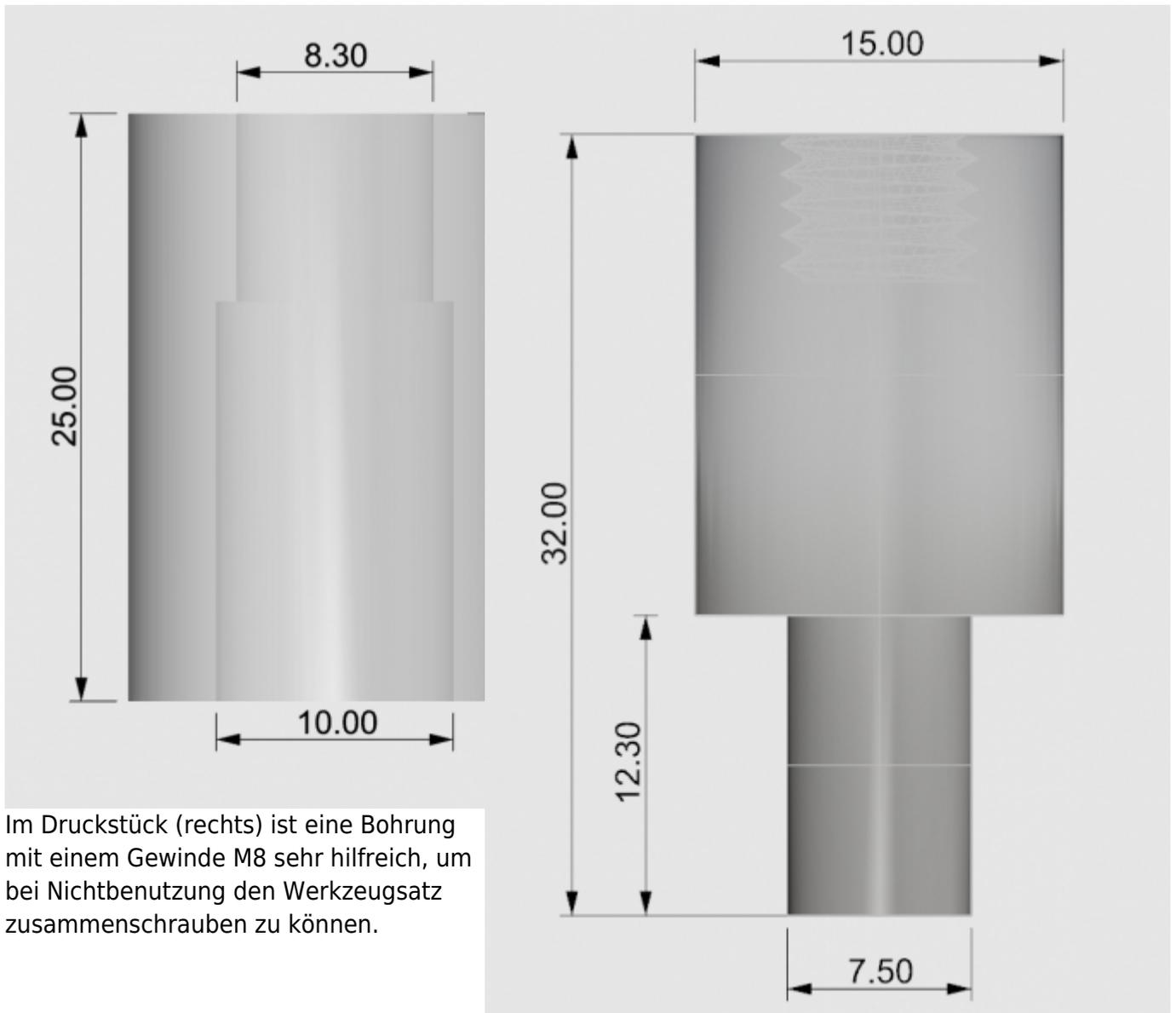
Im Druckstück (rechts) ist eine Bohrung mit einem Gewinde M8 sehr hilfreich, um bei Nichtbenutzung den Werkzeugsatz zusammenschrauben zu können.
