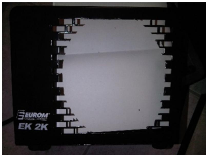
4. den angepassten Wandflansch mit der ausgeschnittenem Lüftungsgitter am Heizgerät montieren und Schlauch aufschieben
